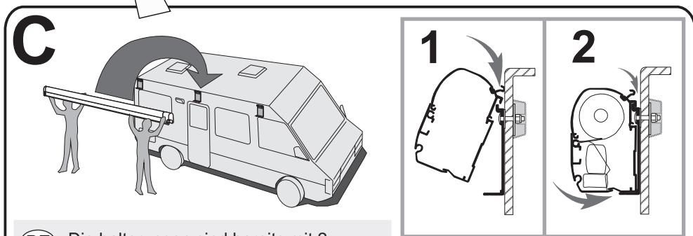
**DE** Die halterungen sind bereits mit 2 Bohrungen vorgesehen: für die Anbringung der Markise ist nur eine Schraube (in der Ausstattung) erforderlich; die einfache Bohrung verwenden.
