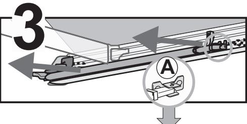
**DE** **Achtung Sicherheit** Das Endstück des Stützfußes A wurde so entwickelt, dass ein falsches Positionieren in der Frontblende (wodurch sich die Frontblende nicht korrekt schließen würde) während der Markisenschließung verhindert wird; es wird daher empfohlen, dies auf die richtige Art und Weise, mit der Basis zur Front hin, zu positionieren.
