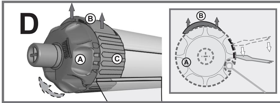
**DE** Funktionszweck. Durch das Drehen der Spannschraube (A) im Uhrzeigersinn, dehnt sich der Flansch (B) zunehmend aus: reguliert sich durch die Einkerbungen an der Abdeckung (C).
