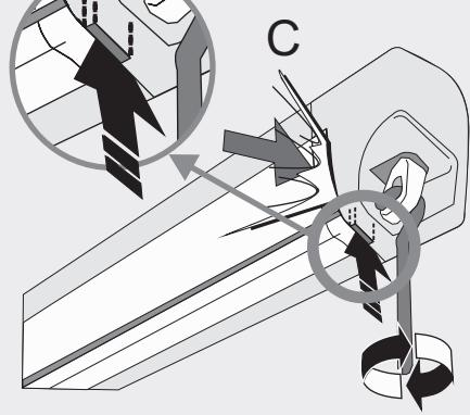
**DE** Bei komplett eingefahrener Markise ist die rote Anzeige nicht mehr sichtbar. Die Markise ist jetzt verriegelt. Die Verriegelung erfolgt ohne spürbaren Widerstand.
